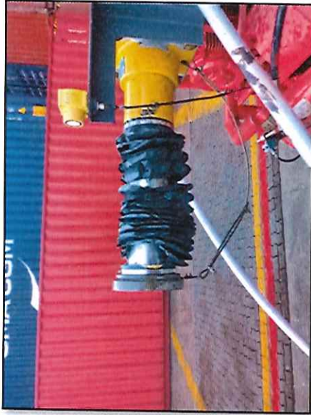
Local: Gantry Item # 08: buffer lado esquerdo/terra com coifa de proteção rasgada.
