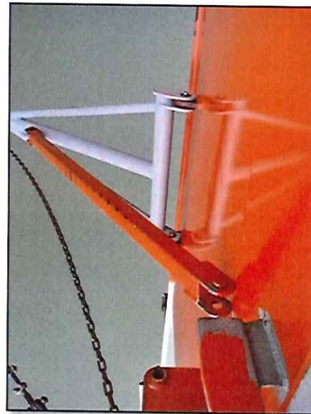
Local: Lança Item # 55: pino do braço do cabo anti-colisão se encontra quebrado. Status: corrigido.
